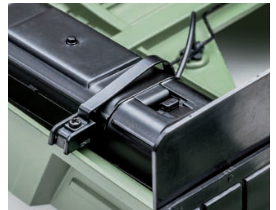
Шаг 4. Установите кронштейн хомута крепления топливного бака с нижней стороны пола кузова (в передней части топливного бака). Поверх кронштейна разместите хомут крепления топливного бака. Закрепите детали на полу кузова винтом 1,7×4 (АР).
