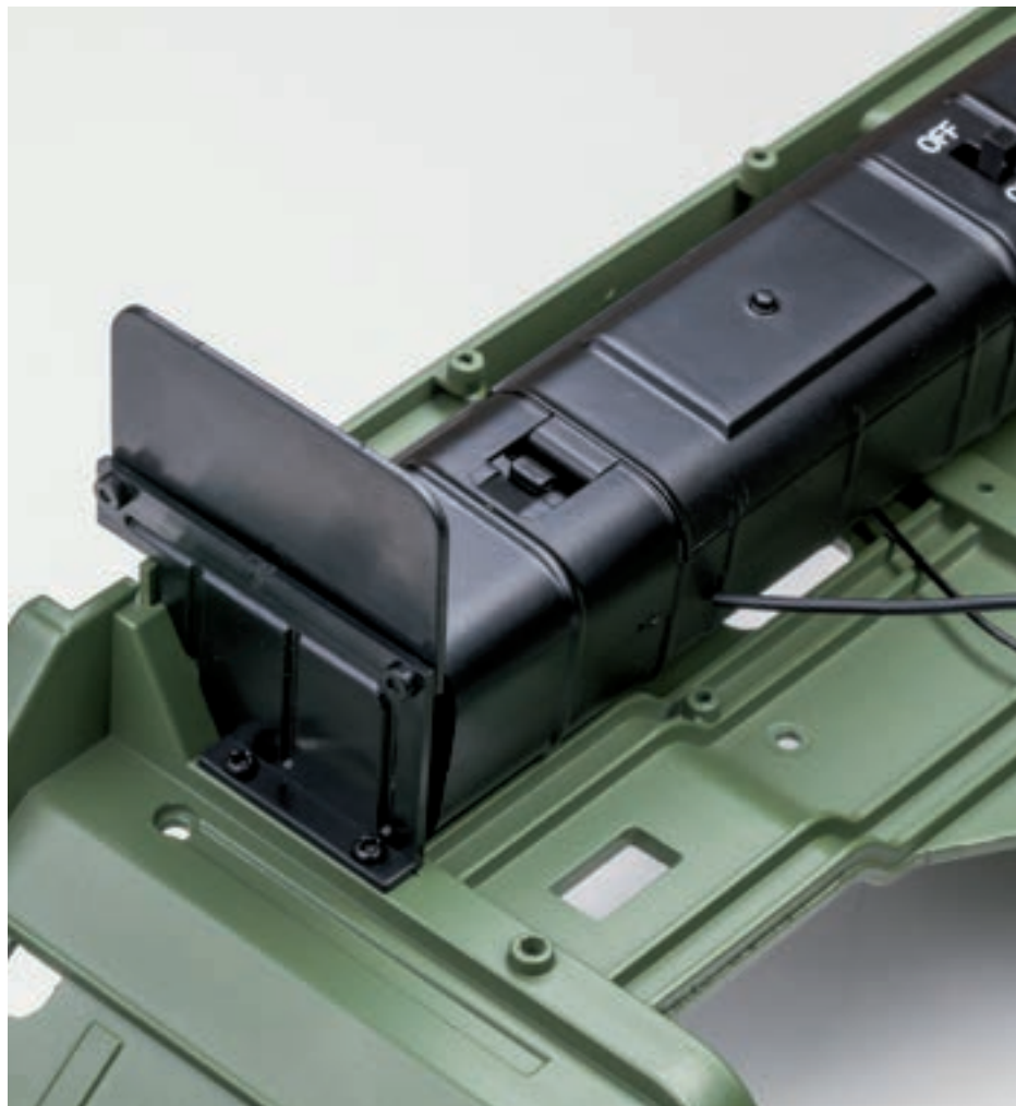
Шаг 3. С нижней стороны пола кузова установите и закрепите двумя винтами 1,7×4 (СМ) грязезащитный щиток переднего левого колеса.
