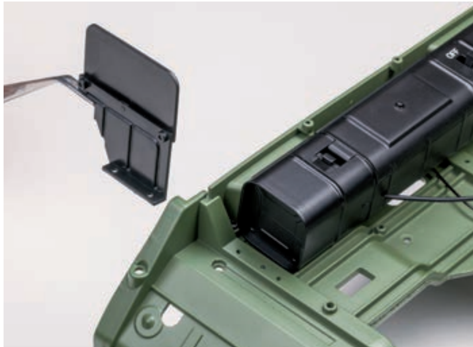
Шаг 3. С нижней стороны пола кузова установите и закрепите двумя винтами 1,7×4 (СМ) грязезащитный щиток переднего левого колеса.
