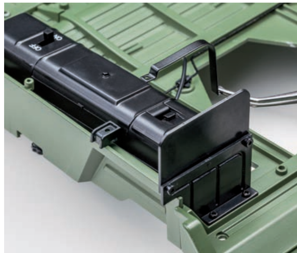
Шаг 4. Установите кронштейн хомута крепления топливного бака с нижней стороны пола кузова (в передней части топливного бака). Поверх кронштейна разместите хомут крепления топливного бака. Закрепите детали на полу кузова винтом 1,7×4 (АР).
